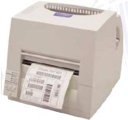
Dieser Etikettendrucker wurde gewählt, weil er neben einer einfachen Handhabung auch eine sehr hohe Bestromung (Energiefluss auf den Druckkopf) auf die zahlreichen Dioden in der Druckleiste bringt. Das ist besonders wichtig, da die einzelnen Dioden punktuell so heiß werden müssen, dass der Harz des Thermobandes nicht nur warm wird sondern auch richtig schmilzt und eine tiefe Verbindung mit dem Kunststoff-Etikett erfolgt. Nur so entsteht ein langlebiges, widerstandsfähiges Druckbild.
